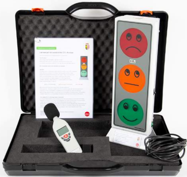
Die Lärmampel mit CO 2 -Sensor zeigt an, sobald es im Raum zu laut oder wann es Zeit zum Lüften ist Quelle: Land OÖ/Schöftner
